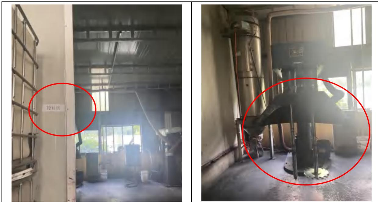
功能性纳米有机颜料分散体--投配料粉尘：投料隔间+集气罩收集
